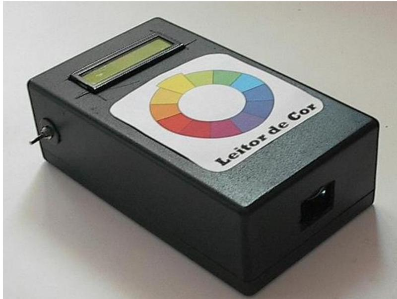
Figura 12: Aparelho identificador de cores
